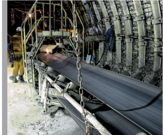
На предлагаемые ленты конвейерные резинотканевые трудногораемые GTP имеется допуск Высшего Горнодобывающего Управления в г. Катовице для применения в подземных горнодобывающих предприятиях.
