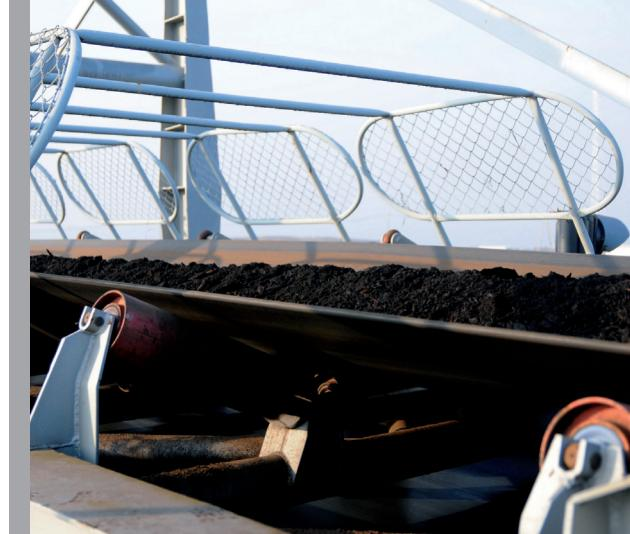
Sve proizvedene transportne gumene trake sa tekstilnim uloškom, opšte namene su antielektrostatičke i zadovoljavaju zahteve za kategoriju bezbednosti 1, prema standardu PN-EN 12882.
