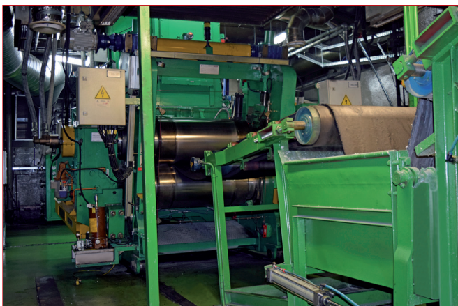
Rys. 2 Nowa linia do produkcji mieszanek gumowych
